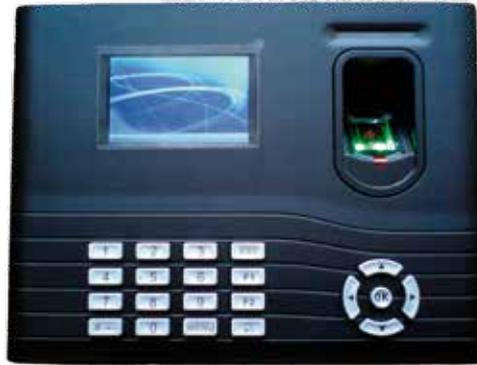
El IN01A es un control de asistencia y acceso biométrico el cual soporta una batería de respaldo de 2000 mAh (batería incluida) para eliminar el problema de posibles fallas en la energía.
